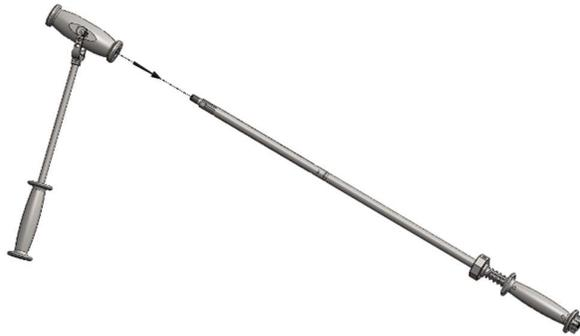
Insérer sur la tige conductrice le levier d'accélération vissé à la masse du marteau.
