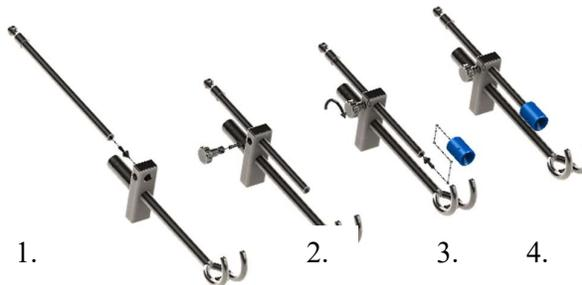
Insérer la tige dans le trou prévu à cet effet sur l'outil d'extraction de tête fémorale (1) et la fixer au milieu à l'aide de la vis de blocage (2, 3). Placer la fixation pour la tête fémorale (3).
