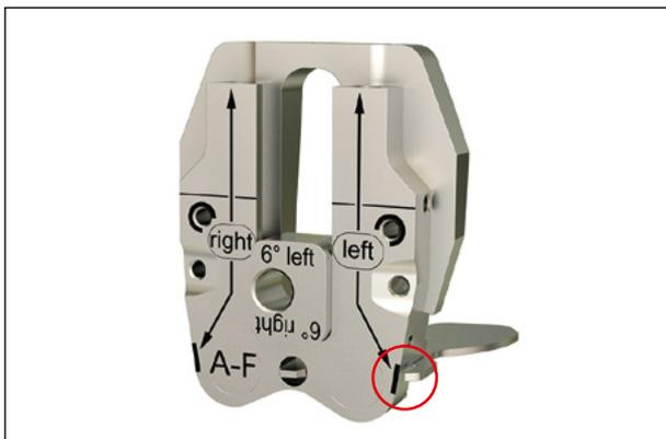
**Fig. 5** Position du pointeur
